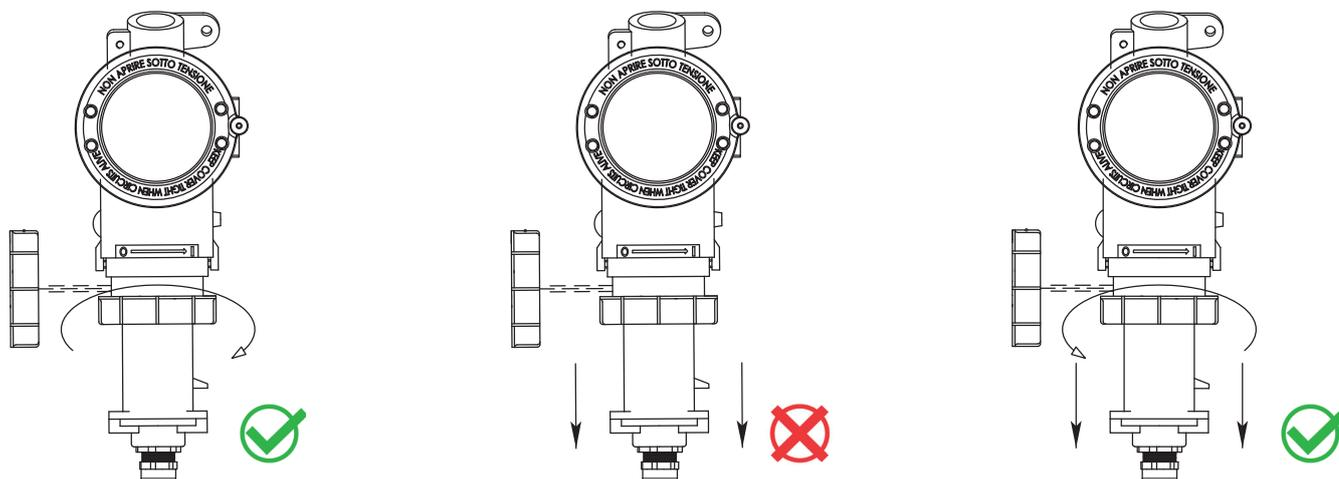
La spina non può essere rimossa dalla presa se non viene ruotata prima in senso antiorario scollegando il circuito elettrico interno.
